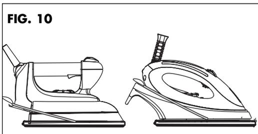
Utiliser la semelle spéciale à **faible température** en positionnant par conséquent le sélecteur en dessous de la position 3 points (fig. 5). Ne jamais utiliser la semelle spéciale à la température maximale.
