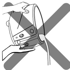
avec deux doigts le tuyau afin d'éviter que l'huile ou la graisse ne coule avant que le tuyau ait été positionné sur un récipient (fig. 8).
