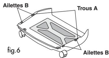
Positionner la façade du poêle sur le socle en veillant à ce que les quatre ailettes "B" qui se trouvent sur celui-ci entrent bien dans les quatre fentes "C" sur le fond de la façade du poêle. Après quoi, pousser l'ensemble façade en avant jusqu'à ce que les ailettes soient parfaitement entrées chacune dans son siège et en veillant à ce que les trous de fixation "A" sur le socle coïncident avec ceux sur la façade (fig.7).
