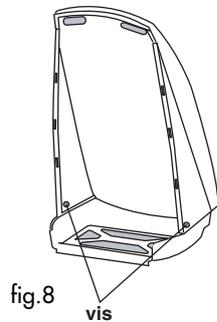
Fixer l'ensemble avec les vis précédemment retirées. Introduire la bouteille de gaz dans l'espace prévu (fig.8).
