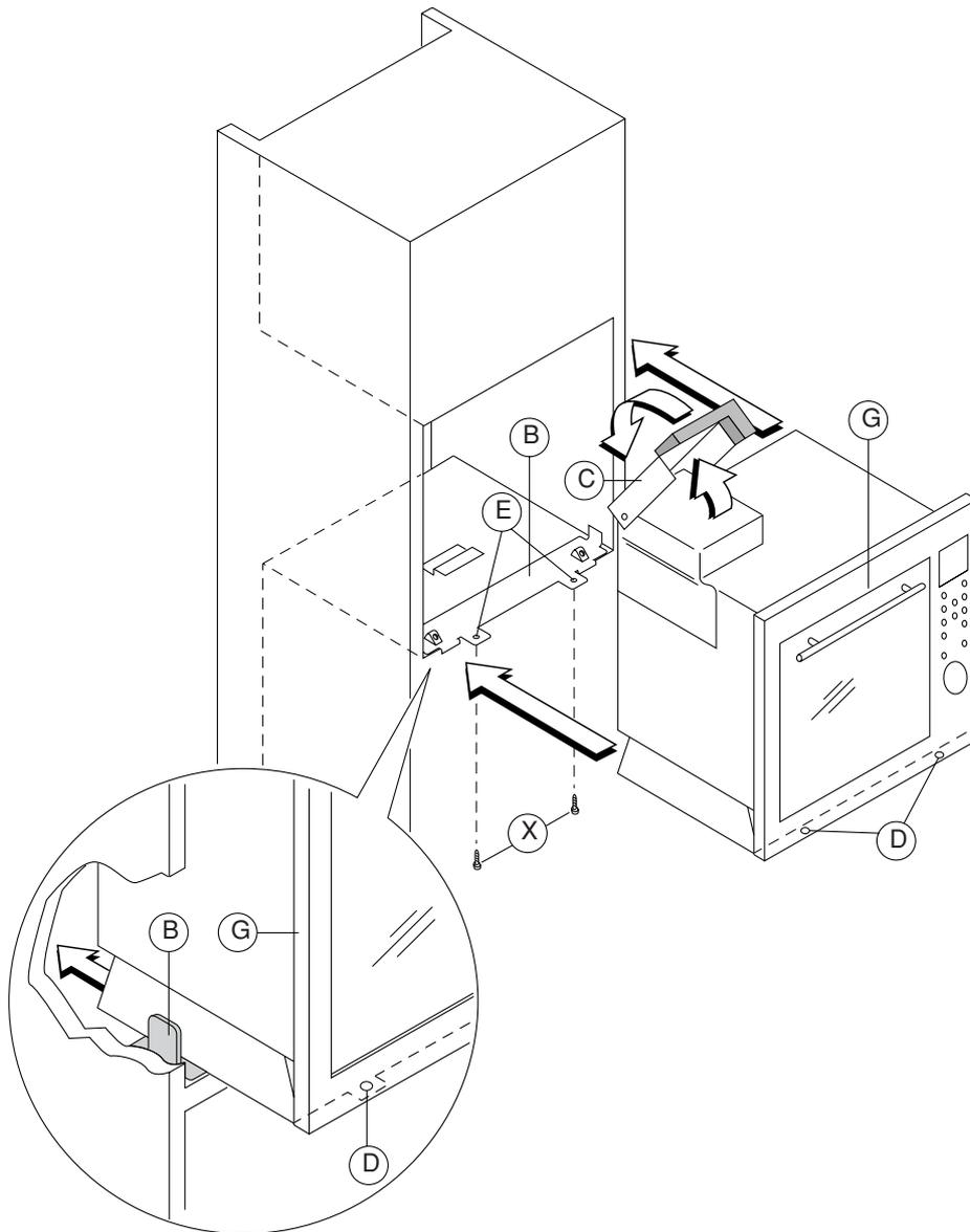
**Remarque:** Lorsque la mise en place est terminée, le câble d'alimentation et la prise de courant doivent être d'accès aisé
