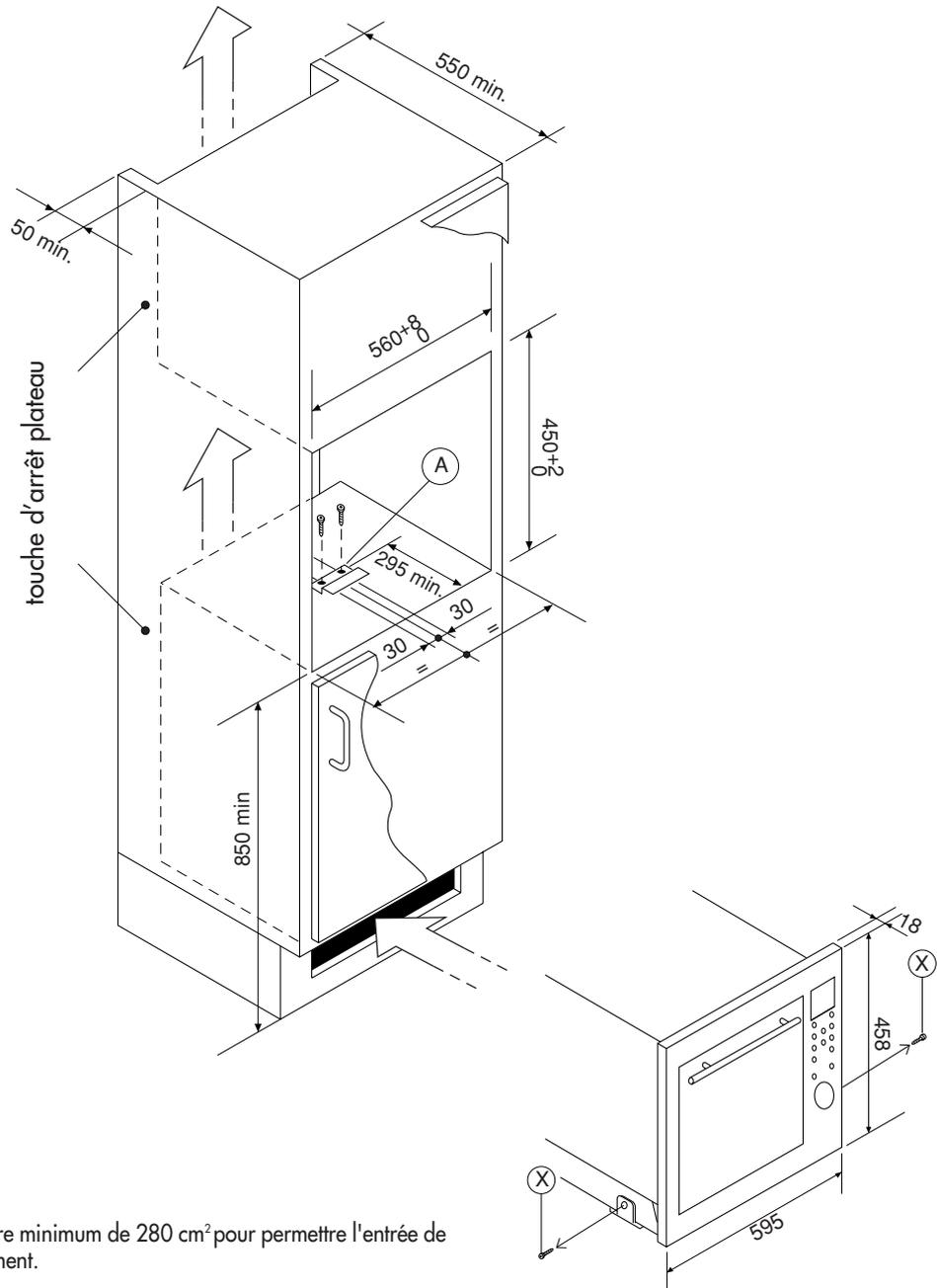
Laisser une ouverture minimum de 280 cm<sup>2</sup> pour permettre l'entrée de l'air de refroidissement.
