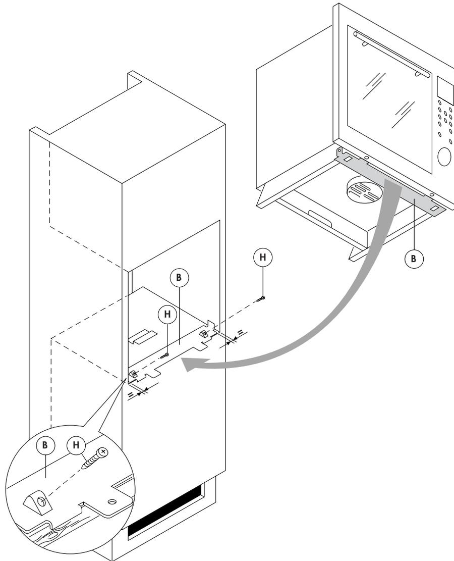
La barre de montage doit être placée de façon à ce que les deux ailettes dépassent du bord du plan d'appui et s'y adossent.
