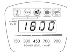
Sélectionner le niveau de puissance des micro-ondes en appuyant à plusieurs reprises sur la touche **POWER LEVEL** (3) de manière à faire clignoter la puissance souhaitée exprimée en chiffres au-dessous de l'afficheur. Consulter toujours les tableaux présentés au Chapitre 3 pour choisir le niveau de puissance adapté.
