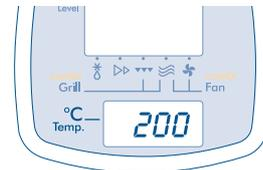
sélectionner la température de cuisson en appuyant sur la touche Temperature (4) par pressions successives jusqu'à ce que l'afficheur 2 (en bas) visualise la température souhaitée. Consulter toujours les tableaux présentés au Chapitre 3 pour choisir la température adaptée.
