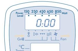
sélectionner le niveau de puissance des micro-ondes en appuyant sur la touche **Power Level** (5) par pressions successives jusqu'à ce que le symbole du niveau de puissance souhaité apparaisse sur l'afficheur 1. Consulter toujours les tableaux présentés au Chapitre 3 pour choisir le niveau de puissance adapté.
