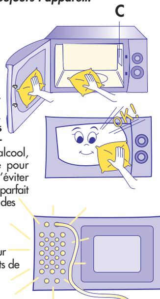
Nettoyer régulièrement les orifices d'entrée de l'air situés à l'arrière du four afin qu'ils ne soient pas obstrués avec le temps par la poussière et des dépôts de saleté.
