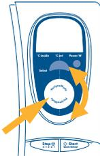
**1** Tourner le bouton RECIPES/MODES (4) jusqu'à l'apparition du nom de la recette désirée dans la partie inférieure de l'afficheur.
