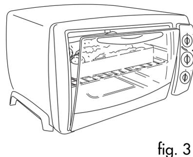
Pour gratiner des aliments déjà cuits, poser le plat directement sur la grille centrale (2) ; la porte doit rester entrouverte (figure 3). Un signal sonore annoncera la fin de la cuisson ; si celle-ci termine avant le temps programmé, remettre le bouton de marche et minuterie (G) sur "0".
