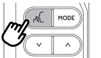
En activant cette fonction, le bruit de fonctionnement est ultérieurement réduit. Pour l'activer, appuyez sur le bouton
