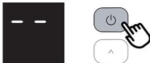
Effleurez la touche
