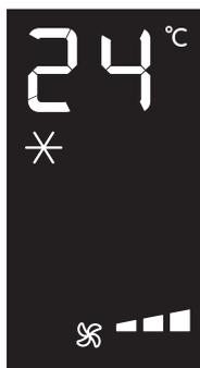
Ce mode est idéal par temps chaud et humide lorsque la pièce doit être refroidie et déshumidifiée.
