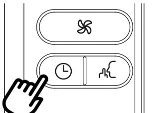
La minuterie permet le démarrage ou l'arrêt retardé de l'appareil. Cette fonction évitera le gaspillage d'électricité en optimisant les périodes de fonctionnement.
