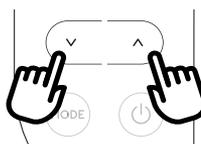
La température peut être affichée en °C ou °F. Pour modifier l'unité de mesure de la température, appuyez sur les touches d'augmentation ^ (C4) ou de diminution v (C3) pendant environ 10 sec.
