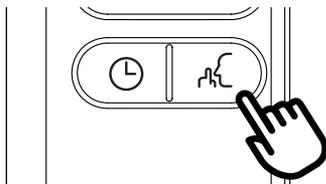
En activant cette fonction, le bruit de fonctionnement est ultérieurement réduit. Pour l'activer, appuyez sur le bouton
