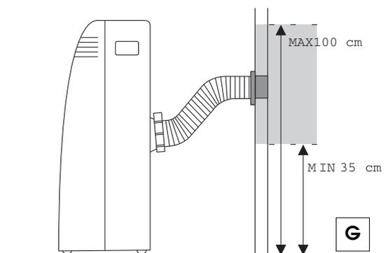
Quand le tuyau 12 n'est pas raccordé, il est conseillé de boucher le trou avec le bouchon de la bride 11.
