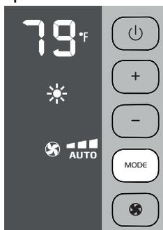
C'est idéal au printemps et en automne lorsque les températures extérieures ne sont pas particulièrement sévères. Pour ce mode, l'appareil doit être préparé de la même manière que pour le conditionnement de l'air, avec le tuyau d'évacuation d'air (**B2**) fixé.
