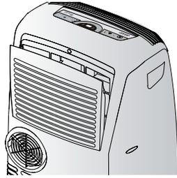
Aspirez la poussière qui s'est déposée sur le filtre. Si le filtre est très sale, plongez-le dans de l'eau tiède et rincez-le plusieurs fois. La température de l'eau doit être inférieure à 40°C. Après l'avoir lavé, laissez-le sécher. Remontez le filtre en le plaçant à nouveau dans son logement.
