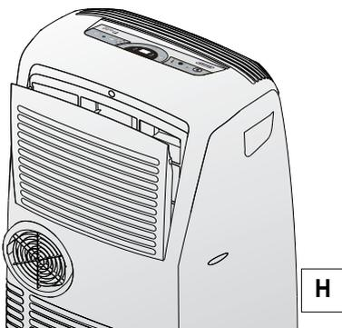
Aspirez la poussière qui s'est déposée sur le filtre. Si le filtre est très sale, plongez-le dans de l'eau tiède et rincez-le plusieurs fois. La température de l'eau doit être inférieure à 40°C.
