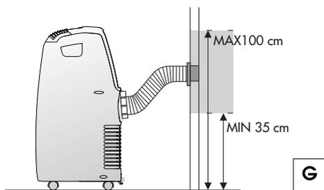
Quand le tuyau **12** n'est pas raccordé, il est conseillé de boucher le trou avec le bouchon de la bride **11**.
