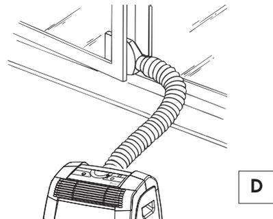
Le tuyau d'évacuation de l'air doit être inséré dans la traverse de façon d'expulser l'air à l'extérieur parmi de la traverse.
