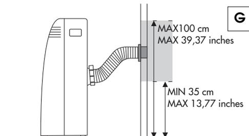
Quand le tuyau (9) n'est pas en place, le trou percé peut être fermé avec le bouchon de la bride (11).
