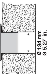
dans le mur: nous conseillons d'isoler la section du mur avec un matériau isolant approprié.
