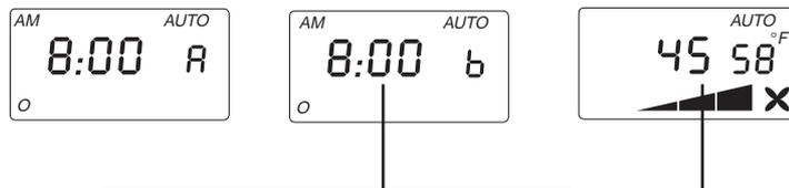
Temps de démarrage programme A    Temps de démarrage programme B    temps de fonctionnement
