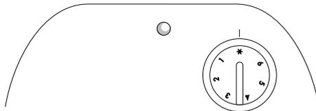
L'appareil s'allume en tournant le bouton en sens horaire jusqu'à l'arrêt en position maximale et en appuyant sur l'interrupteur à pédale.
