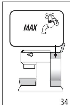
8. La machine est prête pour le rinçage à l'eau froide et claire. Extraire le réservoir d'eau, le vider, le rincer à l'eau courante, le remplir d'eau fraîche jusqu'au niveau MAX (fig. 34) et le réintroduire dans la machine.
