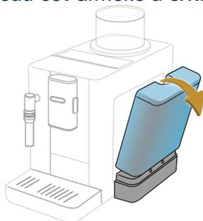
*Inclinez le réservoir vers l'extérieur : une fois décroché, il s'extrait facilement.*
