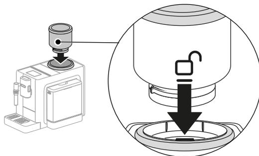
*Tourner le bac à grains dans le sens des aiguilles d'une montre jusqu'à aligner la position de verrouillage
