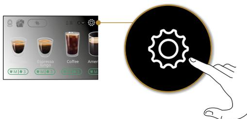
*Faites défiler les pages jusqu'à ce que l'option « Rinçage » s'affiche et appuyez sur « Oui » pour lancer la distribution : après quelques secondes de l'eau chaude s'écoule, qui nettoie et chauffe le circuit interne de la machine.*
