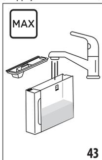
12. Après l'avoir vidé, repositionnez le récipient utilisé pour récupérer la solution détartrante sous les bacs verseurs et appuyez sur « Suivant » pour lancer le processus de rinçage ;
