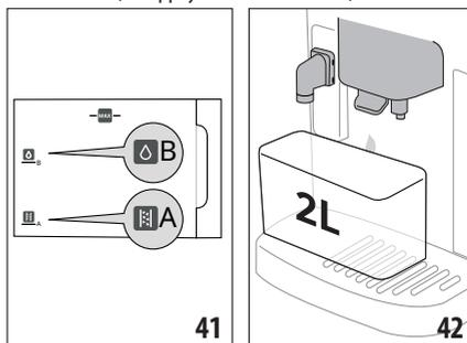
9. Positionnez un récipient vide ayant une capacité minimale de 2 litres sous les becs verseurs (fig. 42). Appuyez sur « C'est fait » pour lancer le processus.
