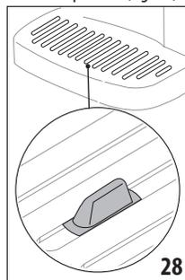
Avant que ce flotteur ne commence à dépasser du plateau d'appui des tasses (A11), il est nécessaire de vider le bac égouttoir et de le nettoyer, pour éviter que l'eau ne déborde et n'endommage la machine, le plan d'appui ou la zone autour. Pour retirer le bac égouttoir, procédez de la manière suivante :
