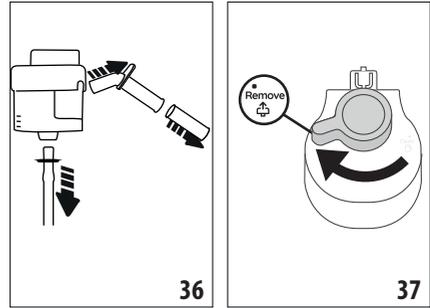
3. Tournez la manette de réglage mousse dans le sens des aiguilles d'une montre (E3) jusqu'à la position **Remove** (fig. 37) et retirez-la ;
