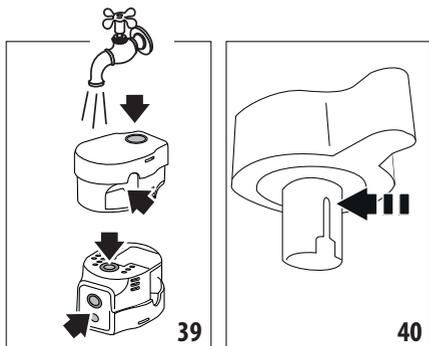
7. Vérifiez également que le tube plongeur et le tube d'écoulement ne sont pas bouchés par des résidus de lait ;
