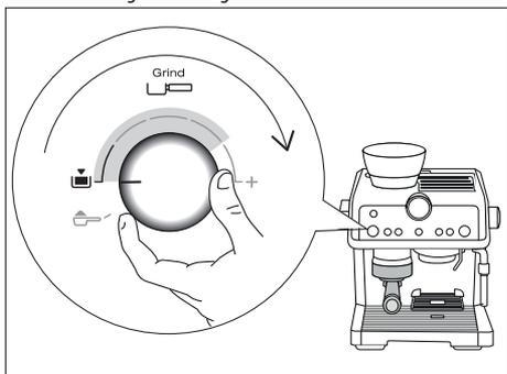
En réglant ce bouton, il est possible d'adapter la mouture à tout type de café et, dans le temps, à l'usure progressive des meules.
