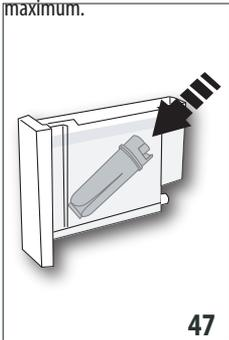
5. Pour activer le filtre, faire couler de l'eau du robinet dans l'orifice du filtre comme indiqué sur la fig. 46, jusqu'à ce que l'eau sorte par les ouvertures latérales pendant plus d'une minute. Appuyer sur
