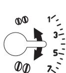
Si le café sort trop lentement ou s'il ne sort pas du tout, tourner d'un cran dans le sens des aiguilles d'une montre vers le numéro 7.
