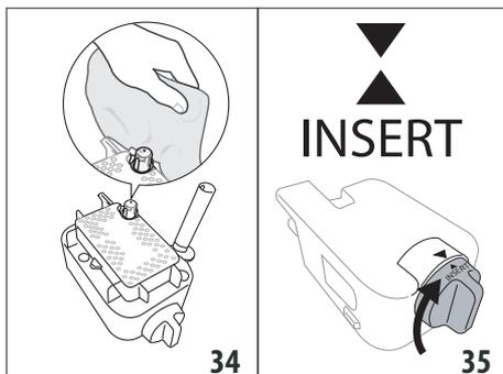
4. Tourner dans le sens des aiguilles d'une montre le bouton de réglage mousse (E2) jusqu'à la position « INSERT » (fig. 35) et l'ôter ;
