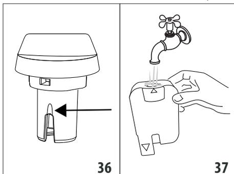
7. Rincer l'intérieur du logement du bouton de réglage de la mousse à l'eau courante (fig. 37) et l'orifice d'enclenchement du mousser à lait à la machine ;
