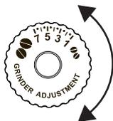
Si le café sort trop lentement ou s'il ne sort pas du tout, tourner d'un cran dans le sens des aiguilles d'une montre vers le numéro 7.
