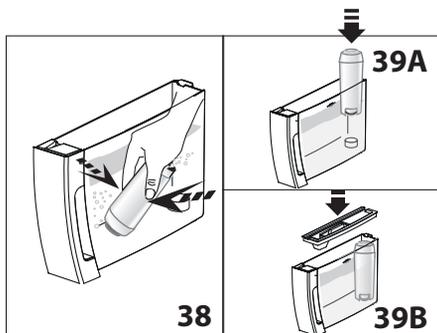
6. Insérer le filtre dans le logement prévu à cet effet (fig. 39A) et l'enfoncer au maximum ;
