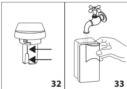
5. Rincer l'intérieur du logement du bouton de réglage de la mousse à l'eau courante (voir fig. 33) ;
