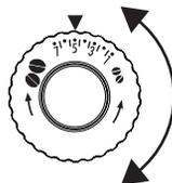
Si le café sort trop lentement ou s'il ne sort pas du tout, tourner d'un cran dans le sens des aiguilles d'une montre.
