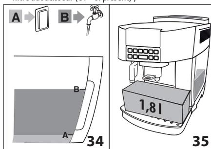
8. Verser le détartrant (C3) dans le réservoir à eau jusqu'au niveau **A** (correspondant à un emballage de 100 ml) imprimé à l'intérieur du réservoir puis ajouter un litre d'eau jusqu'au niveau **B** (fig. 34) ; réinsérer le réservoir dans la machine ;
