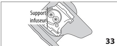
7. Après le nettoyage, remettre l'infuseur en place en l'enfilant dans le support (fig. 33) ; puis appuyer sur l'inscription PUSH jusqu'au « clic » d'accrochage.
