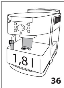
5. Placer sous la buse à cappuccino (A18) et le bec verseur de café (A12) un récipient d'une capacité minimum de 1,8 litres (fig. 36).
