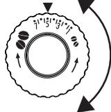
Si le café sort trop lentement ou ne sort pas du tout, tourner d'un cran en sens horaire. En revanche, pour obtenir un café plus dense et crémeux, tourner en sens anti-horaire d'un cran (pas plus d'un cran à la fois autrement le café risque de sortir par gouttes). L'effet de cette correction s'obtient seulement après avoir fait au moins 2 cafés. Si après ce réglage vous n'avez pas obtenu le résultat souhaité, répétez la correction en tournant la manette d'un autre cran.
