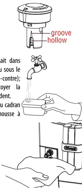
5. Rincer le logement du cadran de réglage de la mousse à l'eau courante (voir figure).
