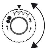
Si le café s'écoule trop lentement ou pas du tout, le tourner d'un cran dans le sens des aiguilles d'une montre vers le n° 7.
