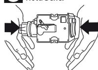
Si l'infuseur ne rentre pas facilement, il est nécessaire (avant de l'insérer) de le placer à la bonne dimension en appuyant avec force simultanément du côté inférieur et du côté supérieur comme indiqué sur la figure.
