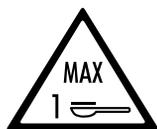
Ne mettez jamais plus d'une cuiller mesure rase sinon l'intérieur de la machine pourrait se salir ou l'entonnoir pourrait s'obstruer.
