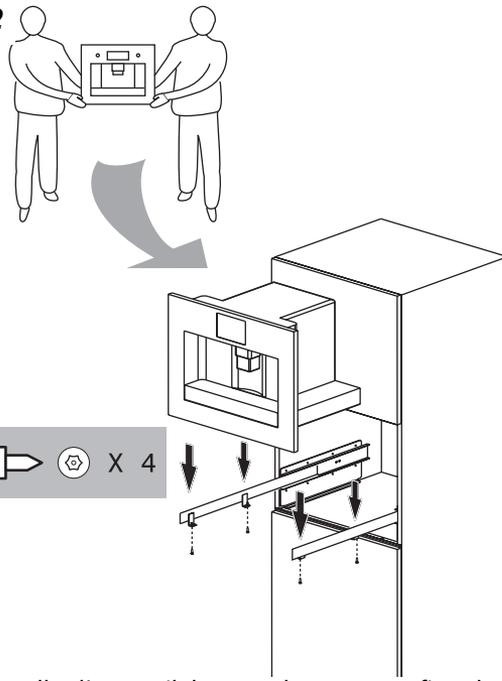
Installez l'appareil dans son logement et fixez-le au moyen des vis.
