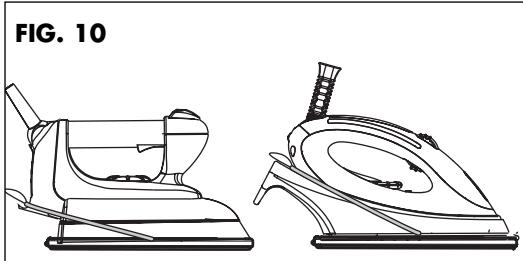
Utiliser la semelle spéciale à **faible température** en positionnant par conséquent le sélecteur en dessous de la position 3 points (fig. 5). Ne jamais utiliser la semelle spéciale à la température maximale.
