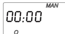
Appuyez de nouveau sur le bouton "Mode" pour ramener l'appareil à son état initial (appareil arrêté et indication "0" à l'écran).
