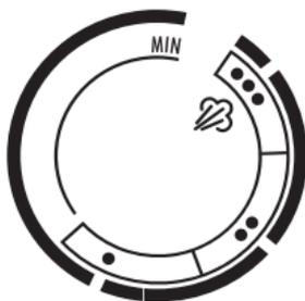
***N'oubliez pas que pour utiliser la fonction vapeur, le thermostat doit être positionné sur le secteur***
