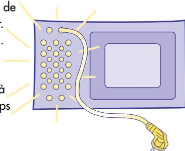
Nettoyer régulièrement les orifices d'entrée de l'air situés à l'arrière du four afin qu'ils ne soient pas obstrués avec le temps par la poussière et des dépôts de saleté.
