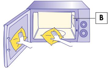
**Ne jamais utiliser de produits abrasifs, éponges métalliques ou objets métalliques tranchants.** En outre, lors du nettoyage de la carrosserie externe du four, veiller à ce que de l'eau ou du détergent liquide **ne pénètre pas à l'intérieur des fentes de sortie de l'air et des vapeurs situées au-dessus de l'appareil.**
