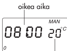
asetettu lämpötila Kuva. 3
