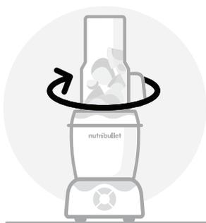
Gire el vaso y colóquelo sobre la base motor, girándolo suavemente en el sentido horario para que se bloquee en la base motor.
