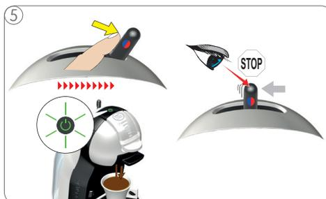
Mueva la palanca hacia la derecha para bebidas calientes y a la izquierda para bebidas frías. Comience la preparación de la bebida. Espere hasta que la palanca vuelva al centro y termine la extracción de agua. El proceso de preparación puede pararse de forma manual colocando la palanca en posición central.
