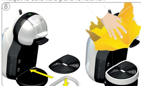
8 Colocar la rejilla recoge gotas sobre la bandeja recoge gotas. Luego insertar la bandeja recoge gotas en la posición deseada de la máquina. Limpiar la máquina con un paño húmedo y suave. Secarla después con un paño seco y suave.
