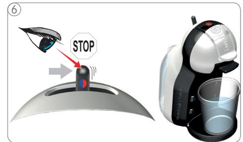
6 Espere hasta que la palanca vuelva al centro y la extracción se detenga. La máquina para el enjuague y el botón de encendido parpadea en rojo durante unos 10 segundos.
