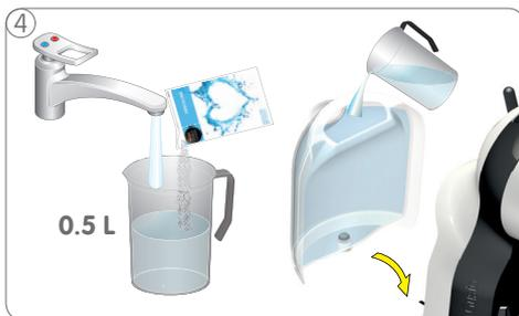
4 Mezcle 0,5 litros de agua con el contenido de un sobre de polvo descalcificador en el depósito de la máquina. Verter la solución de descalcificación en el depósito de agua e insertar el depósito de agua en la máquina.
