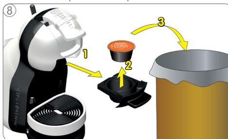
Tirar del soporte de la cápsula y retirar la cápsula usada. Tirar la cápsula.
