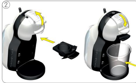
2 Abrir la manija de bloqueo e insertar el soporte de la cápsula vacío. Cerrar la manija de bloqueo. Llene el depósito de agua de la máquina con agua limpia hasta el nivel máximo y colóquelo.
