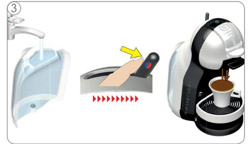
3 Comprobar si hay agua en el depósito de agua: si no es así, rellenar y mover la palanca de nuevo a la posición frío/caliente para continuar la preparación; en caso positivo, proceder del siguiente modo:
