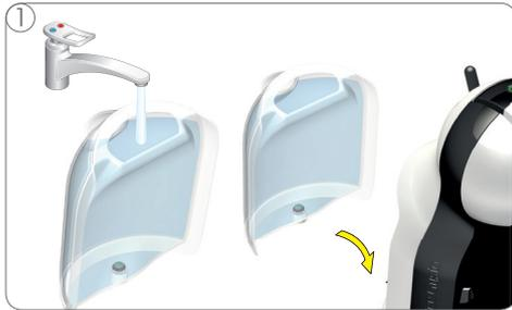
1 Enjuagar primero el depósito de agua. Llene el depósito de agua con agua potable fría y colóquelo en la máquina.
