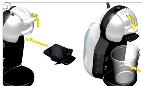
5 Abrir la manija de bloqueo e insertar el soporte de la cápsula vacío. Cierre la palanca de bloqueo. Llene el depósito de agua de la máquina con agua limpia hasta el nivel máximo y colóquelo.
