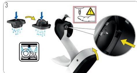
Limpie con líquido detergente y agua potable fresca ambos lados del soporte de la cápsula. Como alternativa puede lavarse en el lavavajillas. Séquelo a continuación. Limpie el cabezal de la máquina alrededor del inyector con un trapo húmedo suave y limpio.
