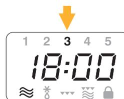
Seleccione el nivel de potencia de las microondas pulsando repetidamente el botón **POWER LEVEL** (5) hasta que parpadea la potencia elegida, expresada en números en la parte superior de la pantalla. Para elegir la potencia, consulte siempre las tablas contenidas en el capítulo 3.
