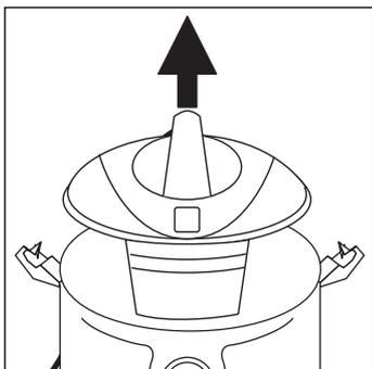
Levante la unidad del motor utilizando el mango correspondiente, quite los accesorios del interior del contenedor (en algunos modelos las ruedas están incorporadas).
