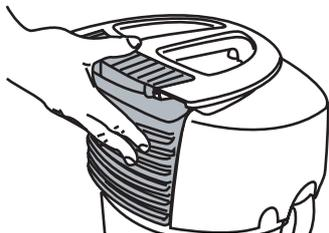
Controle periódicamente que, el flotador, situado en el interior del alojamiento portamotor, pueda moverse libremente en su alojamiento levantando la tapa del aparato y sacudiéndola.
