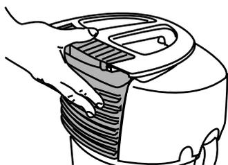
Controle periódicamente que, el flotador, situado en el interior del alojamiento portamotor, pueda moverse libremente en su alojamiento (fig. 11) levantando la tapa del aparato y sacudiéndola.
