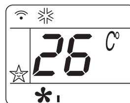
*Nota: La función noche consiente mantener el ambiente a la temperatura más apropiada evitando una excesiva elevación o bajada de la temperatura, con un funcionamiento silencioso. El flujo de aire disminuye, mientras la temperatura del ambiente cambia gradualmente siguiendo las exigencias del bienestar: aumenta 1°C después de 60 minutos y 2°C después de 2 horas (se apaga después de 8 horas).*
