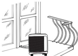
La unidad externa se puede colgar en una pared con las abrazaderas adecuadas. En este caso, proceder de la siguiente manera.
