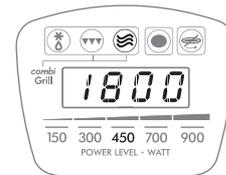
Seleccionar el nivel de potencia de las microondas apretando repetidamente el botón **POWER LEVEL** (3) hasta que la potencia deseada, indicada en números debajo del display sea intermitente. Para la elección de la potencia, consultar siempre las tablas del Capítulo 4.
