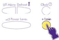
1. Pulsar el mando "+ 1 min." (13). (En el visor aparecen los caracteres 1:00 de modo intermitente y se encienden el segundo indicador de arriba a la izquierda relativo a la función microondas y el primero de abajo a la derecha relativo a la potencia de las microondas).
