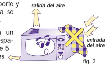
4) No obstruir nunca los orificios de entrada del aire. Sobre todo, no apoyar nada encima del horno y verificar que las aberturas de salida del aire y de los vapores (situadas encima del aparato) estén SIEMPRE DESPEJADAS (Ver Fig. 2 y Fig.3).
