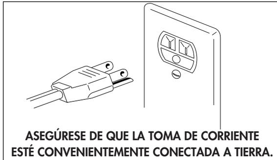
El aparato debe conectarse a tierra. En caso de cortocircuito, la corriente saldrá por el cable de tierra y se reducirá el riesgo de recibir una descarga eléctrica.
